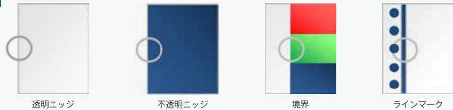
(注意) ウェブエッジや透明のフィルム上の印刷を検出するときは下地のロールと検出対象のコントラストが大きくなるようにロールの表面材質を選択して下さい。(例：光沢のある透明フィルムエッジ検出のときは光沢の無い黒色ロール)
