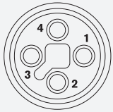
駆動用電源供給コネクタ仕様 (嵌合側から見た図)
