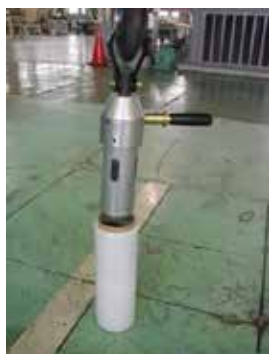
① ロールハンドリングシャフトを巻芯に挿入します。
