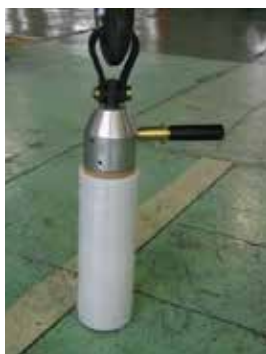
① ロールハンドリングシャフトを巻芯に挿入します。
