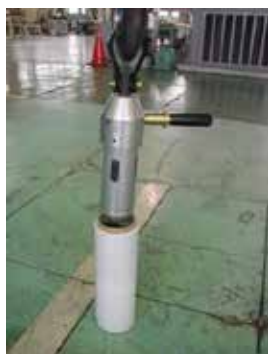
① ロールハンドリングシャフトを巻芯に挿入します。
